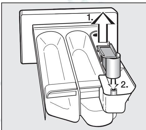
1. Вытащить наружу сифон из отсека и промыть его под струей теплой воды. Трубку, на которую надет сифон, почистить таким же образом.
